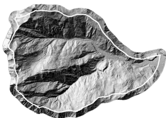
Figura 6: Esempio di nuovo rilievo topografico LiDAR ed ortofoto da aereo effettuati nel 2024 nel bacino del torrente Miozza. Example of a new LiDAR topographic survey and aerial orthophotos conducted in 2024 in the Miozza watershed. Primer nove topografske meritve z LiDAR-jem in ortofotografij, izvedenih leta 2024 v porečju Miozza.
